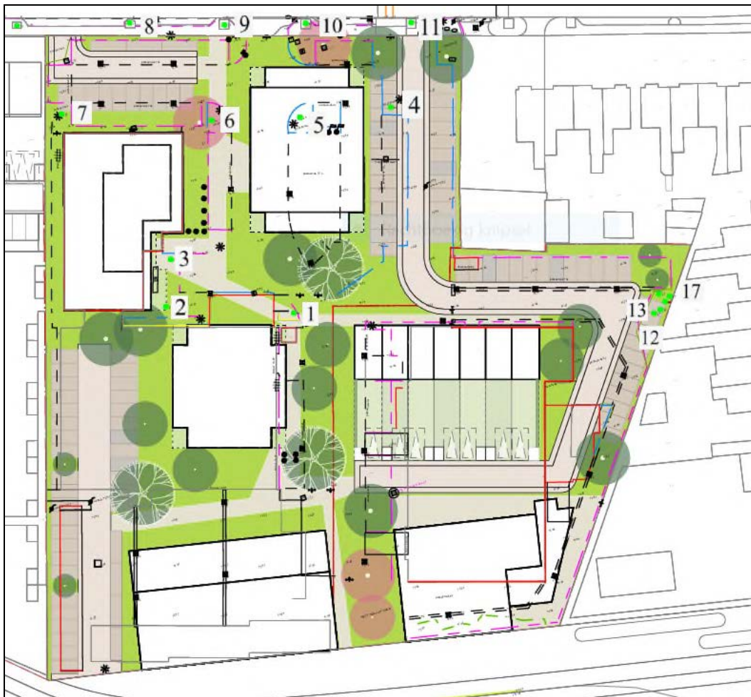
Afb.10. Plattegrond nieuwe situatie, en de locatie van de bestaande bomen (groene punten met nummers).
